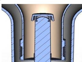
4. При снятии бутыли, клапан автоматически закрывается, предотвращая пролив воды из не полностью опусташённой бутыли.
