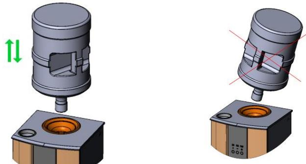
3. Палец, на который насаживается бутыль, автоматически открывает клапан в крышке бутыли и удерживает его в открытом положении до снятия бутыли.
